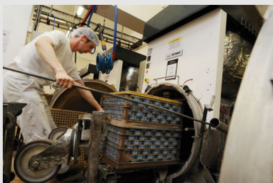
© Patrick Delapierre / INRS Stérilisation des boîtes dans une conserverie
